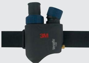
Le régulateur Versaflo™ V-500E garantit un débit d'air régulier et réglable individuellement. Le régulateur requiert une pression de travail comprise entre 3,5 et 8 bars et son niveau sonore est très faible grâce au silencieux intégré (< 65 dBA). Un sifflement d'avertissement intégré prévient l'utilisateur en cas de débit d'air insuffisant dans la coiffe. Conforme aux normes les plus récentes (EN 14594).
